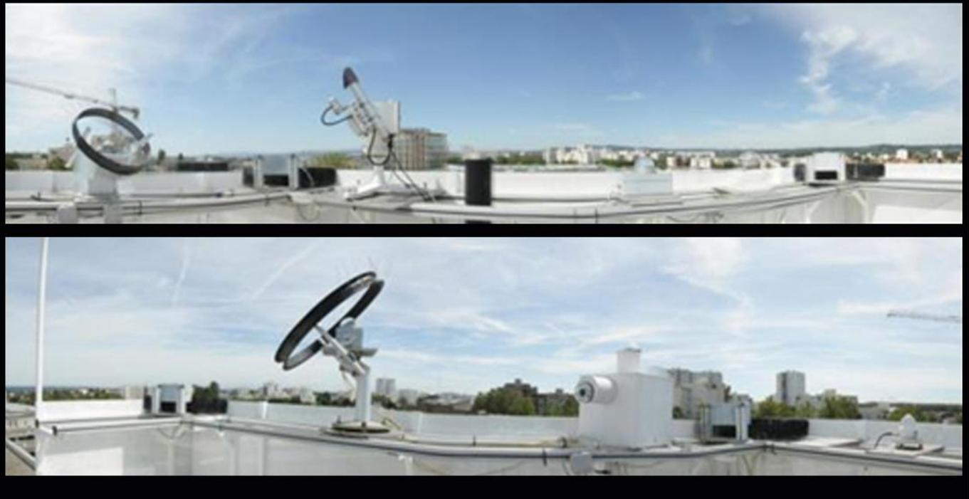
Station de mesure de la lumière naturelle (IDMP) - Mesure de la lumière naturelle et du rayonnement solaire. Les mesures sont accessibles en ligne sur <http://idmp.entpe.fr/mesfr.htm>
