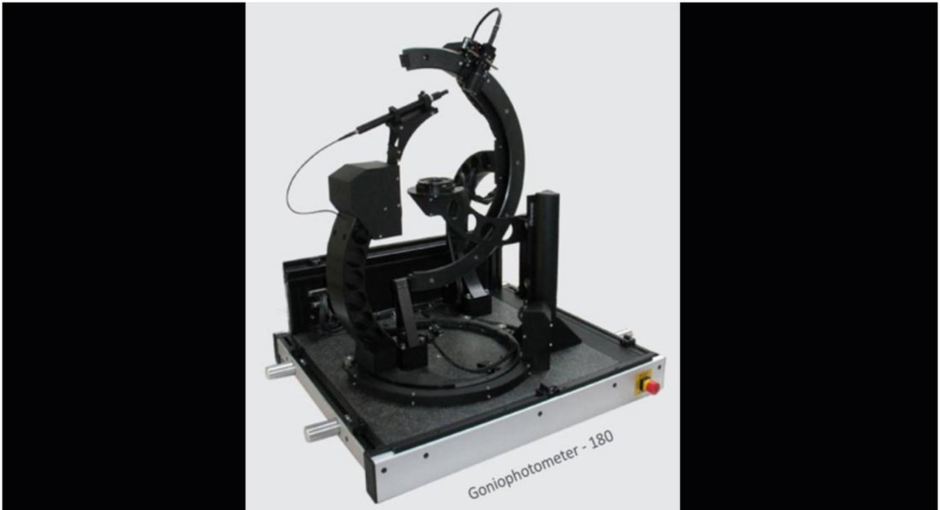
Le spectrogoniophotomètre 3D permet de déterminer les propriétés spectrales de réflexion et de transmission des matériaux dans toutes les directions de l'espace pour une source d'angle d'incidence donné.
