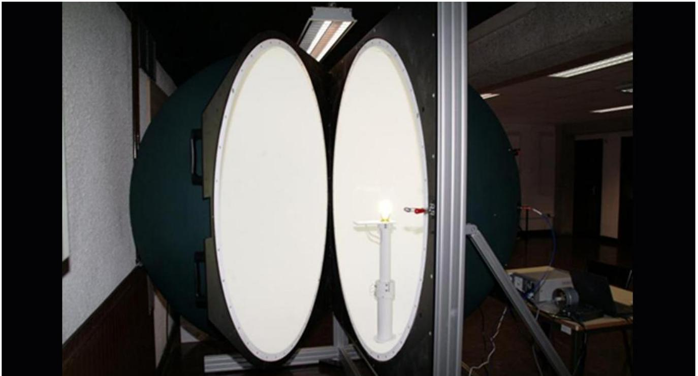
La sphère d'Ulbricht permet de déterminer les caractéristiques spectrales des sources lumineuses de moins de 1m. Par intégration, elle permet la mesure du flux lumineux global émis par une source lumineuse dans toutes les directions.
