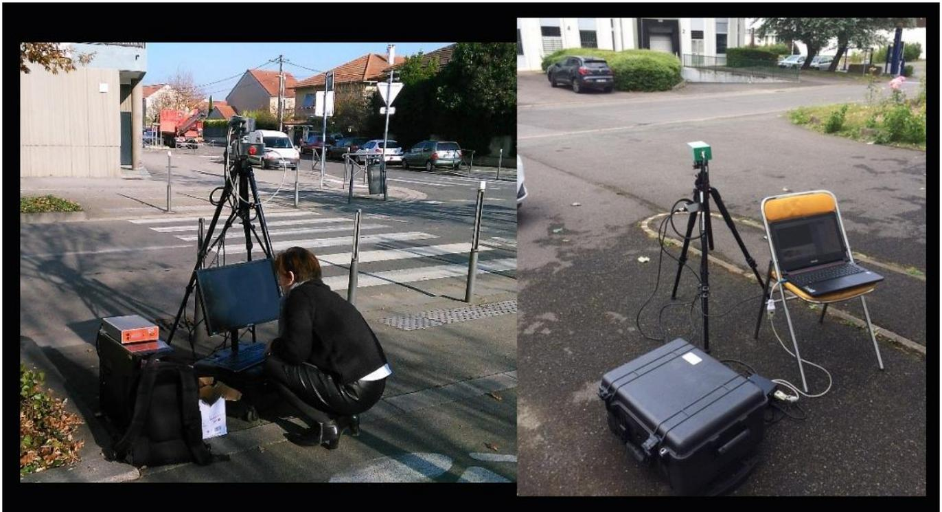
Caméra hyperspectrale portable
