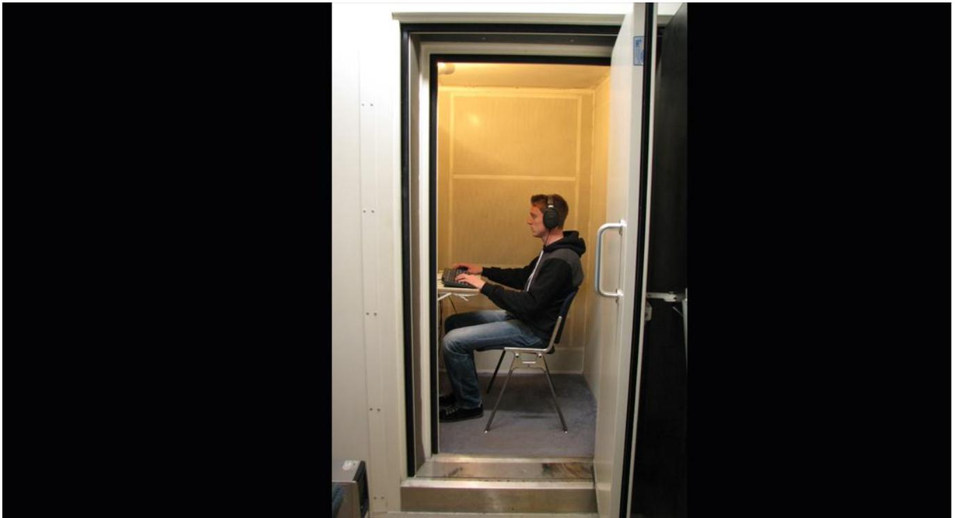
Cabine audiométrique - Cabine à très forte isolation acoustique permettant de réaliser des tests d'écoute au casque et des mesures de seuils auditifs.
