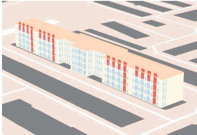
Figure 35 : exemple d'erreur dans Pléiades (fenêtres en conflits avec les parois)
