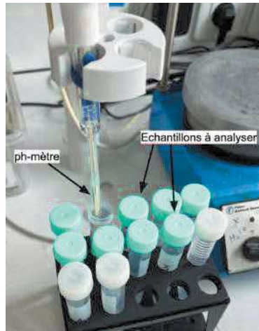
FIGURE 3.13 – Exemple d'utilisation du robot Opentron OT-2 pour la préparation d'échantillons
