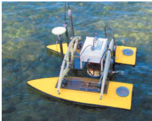
Figure 9 : Exemple de profileur ADCP. (Contrôle des débits réglementaires, ONEMA, 2011) [7]
