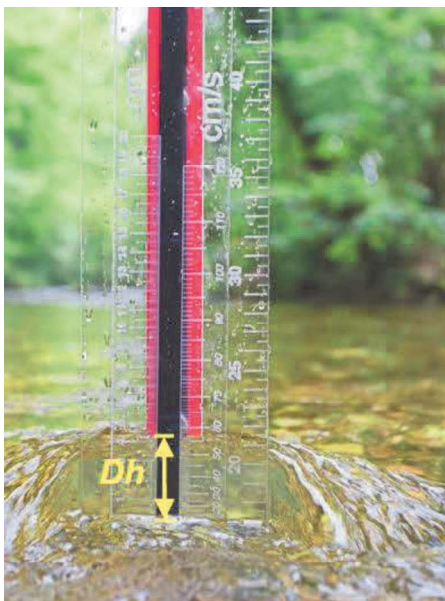
Figure 11 : Illustration de la charge dynamique sur la règle à jauger. (INRAE, Règle à jauger) [16]
